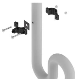
Просверлите отверстие в сливной канализационной трубе (муфта в комплекте предназначена для диаметра 40 мм) под раковиной и подсоедините дренажную муфту для слива из фильтрующего блока и центрального блока. Вам потребуется дрель, сверло по металлу 8 мм и отвертка.
