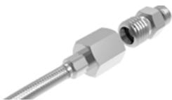
Руками накрутите гайку наконечника DKOL трубки White Ray на ответную резьбу. Гаечным ключом доверните до упора для герметизации.
