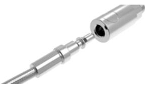
Для присоединения вставьте наконечник композитной трубки в коннектор QUICK до щелчка. Для отсоединения нажмите на кнопку коннектора.
