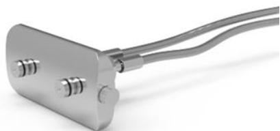
Разветвители типа Gravity имеют 3 резьбовых отверстия для установки форсунок: два спереди и одно сбоку. Это позволяет установить от 1 до 3 форсунок Nova, что соответствует производительности 1,2 или 2,4 или 3,6 литра/час при максимальном давлении.
